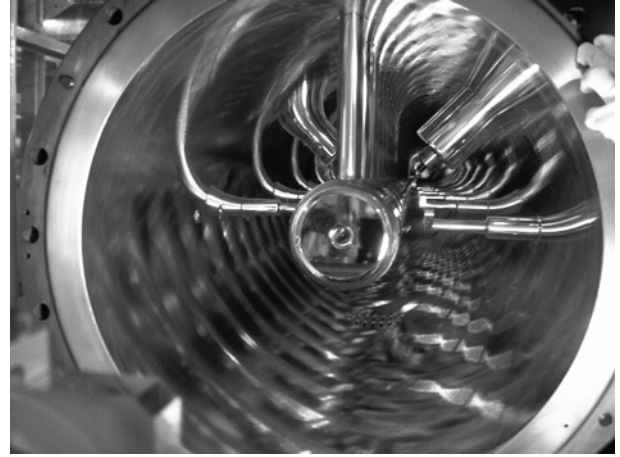
図 28: J-PARC DTL 空洞 (運転周波数 324 MHz) の内部写真。上から吊される形で取り付けられているのがドリフトチューブ。ドリフトチューブ内には水冷式の電磁石が内蔵されている。左右から突きだしている棒状のものは電場を安定化させるためのポストカプラーである (安定化の原理については 5.2 節で述べる)。
